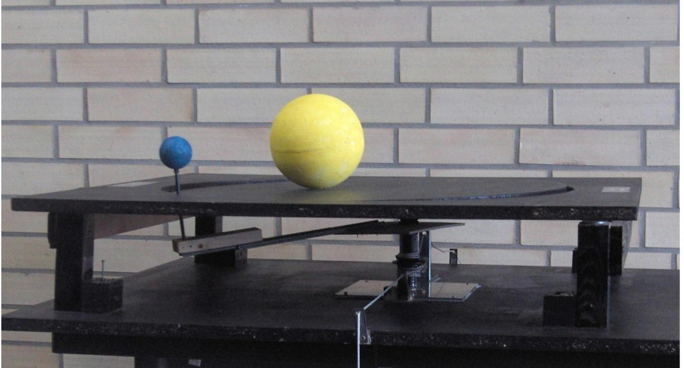
*Wenn Sie am Seil ziehen, läuft der Planet auf seiner Ellipse. Im hier gezeigten Perihel ist der ausziehbare Arm unter der Platte lang, also die Bahngeschwindigkeit hoch.*
