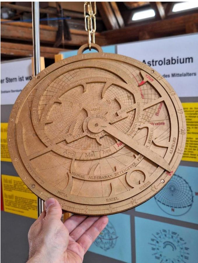
*Für den angeleiteten Experimentiervorschlag sind Marken am Astrolabium hervorgehoben. Die Höhe des Sterns über dem Horizont ist eine Funktion von Datum und Uhrzeit*
