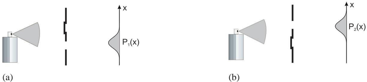
**Abbildung 3.2:** Doppelspaltversuch bei einem geöffneten Spalt mit Farbtröpfchen (klassische Teilchen)
